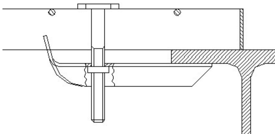
La particolare forma della testa della vite, costituisce un elemento di basso impatto visivo (un bottone 'piatto') ed è predisposta per essere serrata dall'alto con una chiave leggera da 22 mm. Inferiormente il dado quadro M8 (UNI 5596) all'atto della rotazione della vite si serra a questa, impedito nella rotazione, all'interno del rostro in lamiera.
